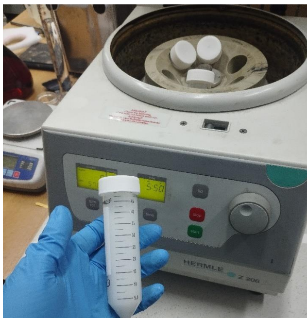
Рисунок 24 – Очистка раствора на центрифуге марки Hermle Z 206
